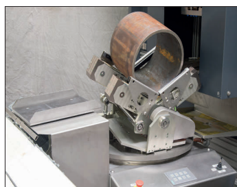
Моторизованный поворотный стол для осмотра муфты с возможностью вращения на 180 градусов
