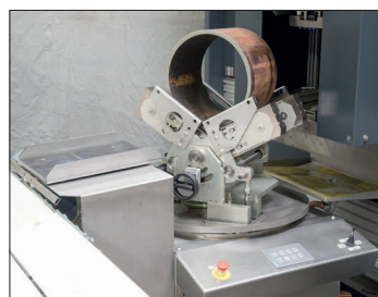
Моторизованный поворотный стол для осмотра муфты с возможностью вращения на 180 градусов
