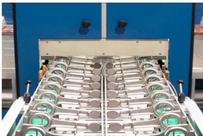
DEUTROMAT с цепной конвейерной линией, контроль 8 деталей за цикл
