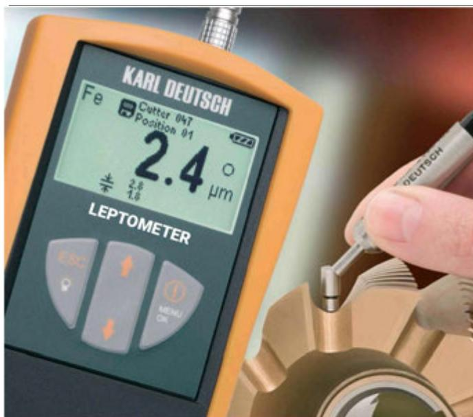
Измерительный прибор с внешним зондом (LEPTOMETER 2042)
