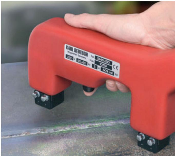
Ручной электромагнит для контроля сварных швов (DEUTROPULS-ручной магнит)
