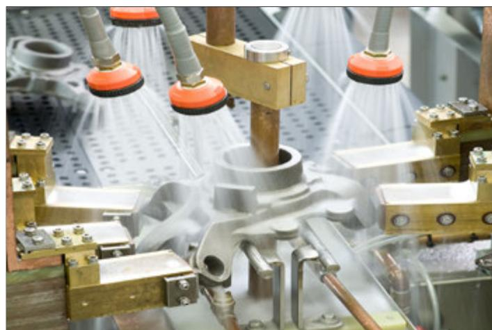
Установка DEUTROMAT с 5 контактами и электрошимами
