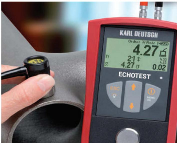
Классическое измерение толщины стенки трубопровода (ECHOTEST 1076)
