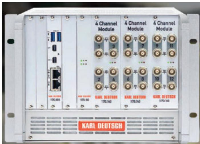
ECHOSCOPE 1170 - Многоканальный дефектоскоп для ультразвукового контроля
