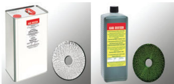
Примеры раскрытия дефектов на эталонных образцах с помощью дефектоскопических материалов KARL DEUTSCH
