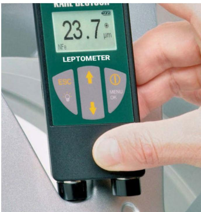
Компактный толщиномер с встроенным преобразователем (Pocket-LEPTOMETER 2026)
