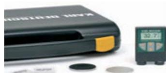
Прибор с калибровочными образцами
