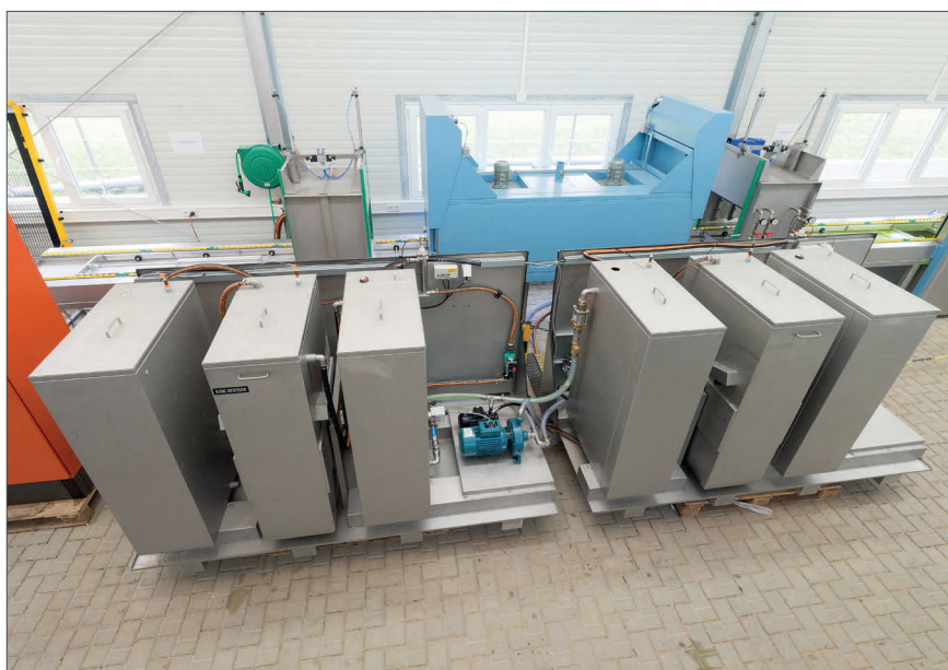
Рециркуляция воды посредством двойной фильтрации с активированным углем.
