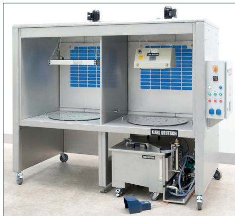
Двойной контрольный стенд: для красного пенетранта(слева); для люминесцентного пенетранта(справа)
