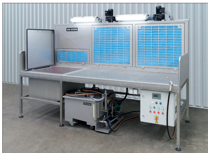
Испытательный стенд с погружным резервуаром для пенетранта и визуальной оценкой при белом свете
