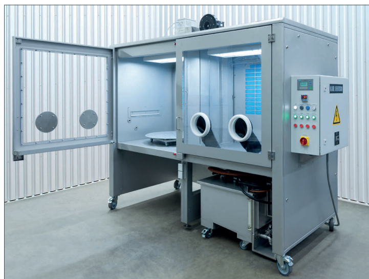
Специальный контрольный стенд с дверцами для защиты от брызг и встроенной сушилкой
