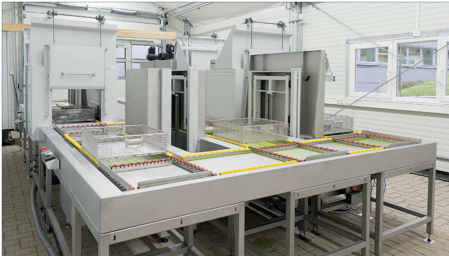
Полуавтоматизированная линия капиллярного контроля со станцией предварительной очистки и 2 погружными баками для пенетрантов разной чувствительности
