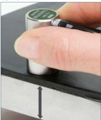
Измерение через покрытие
