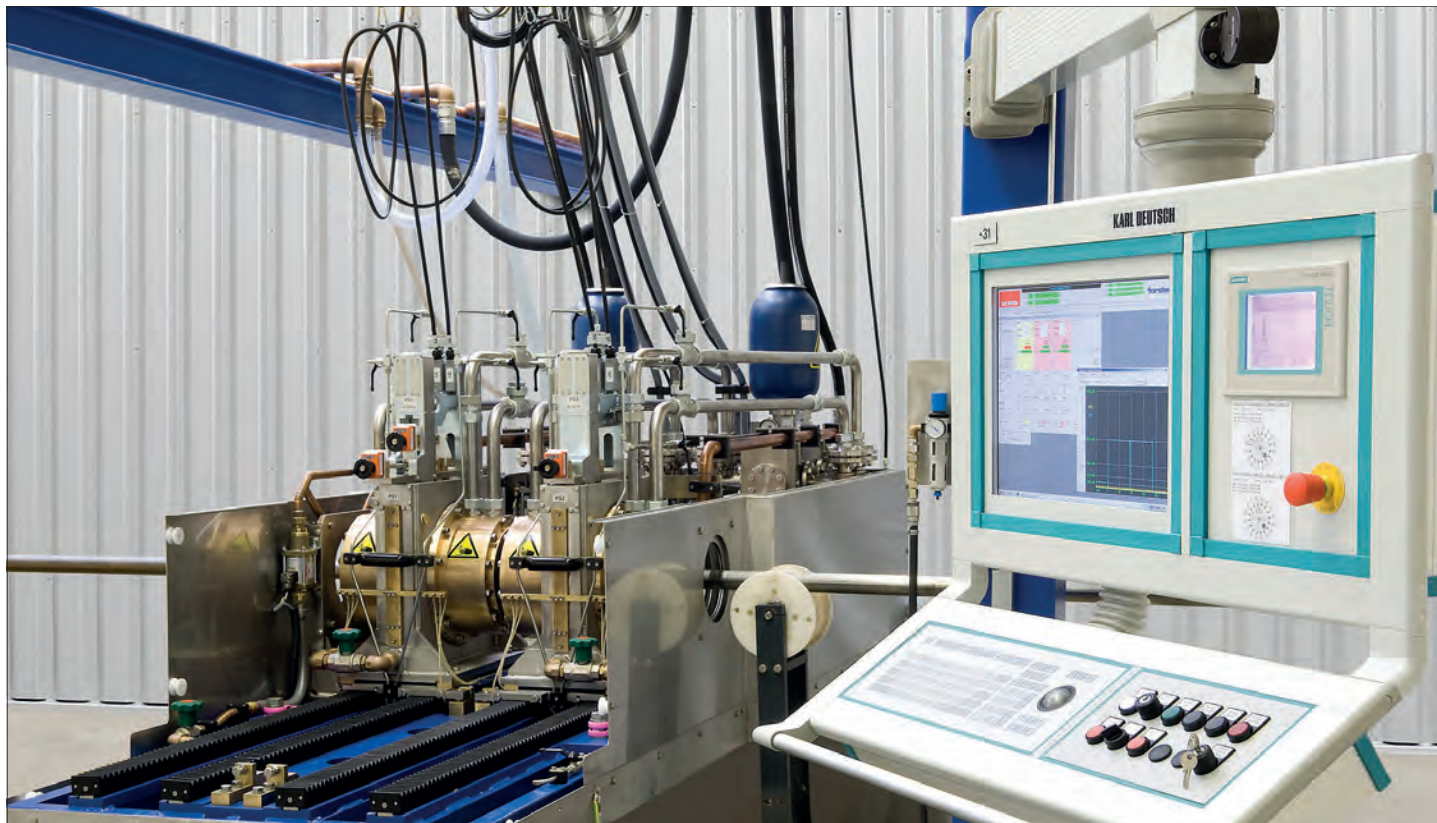
Система для контроля труб и панель оператора для настройки параметров ультразвукового контроля и параметров ПЛК (Siemens).
