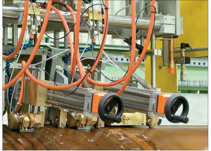
Акустические блоки для обнаружения продольных дефектов: Шпиндели с устройством для определения положения объекта используются для регулировки расстояния между преобразователем и сварным швом.
