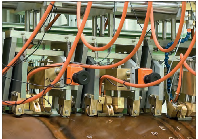
Акустические блоки для обнаружения расслоений в околошовной зоне
