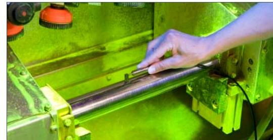
Пример: Измерение силы тангенциального поля при намагничивании
