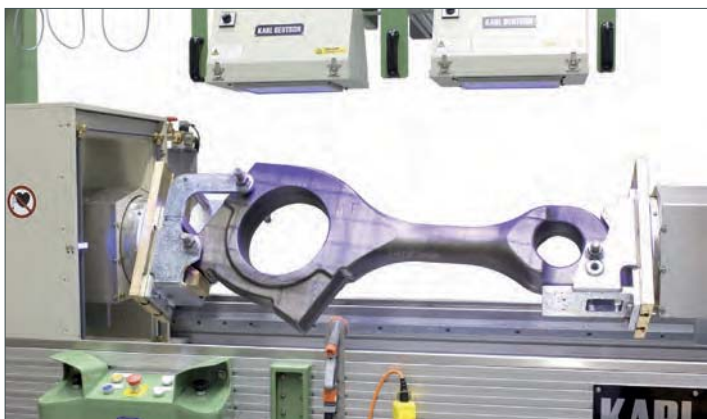
Планшайба с электроприводом для вращения соединительных тяг кораблей внутри установки во время визуального контроля. Передвижные пневматические УФ - лампы.
