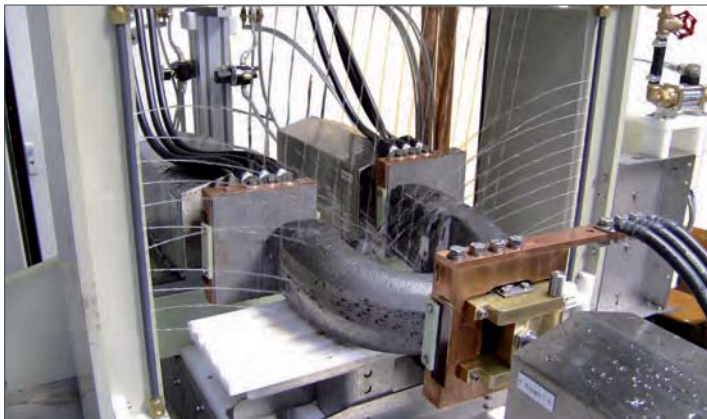
Специальная установка с тремя контактами (3000 А каждый) для контроля якорных (вертлюжных) смычек якорной цепи.
