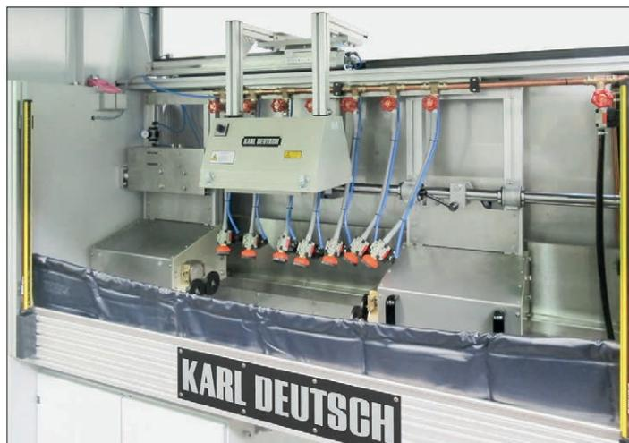
UMT 900 с пневматически перемещаемым держателем УФ-лампы для облегчения загрузки детали сверху
