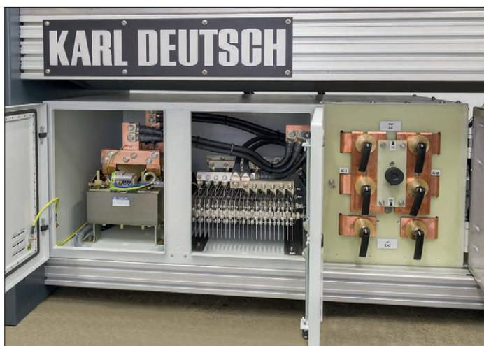
UMT 600 с AC / FWDC для преобразования тока, где коммутационное устройство для AC-FWDC расположено справа
