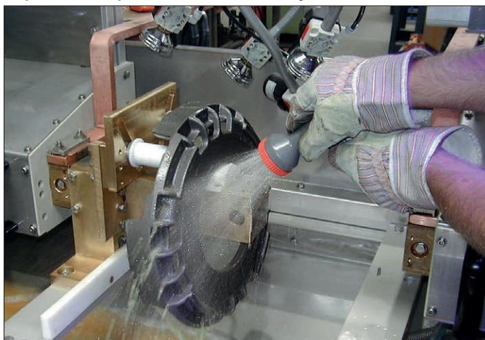
UMT 900 с намагничивающей оснасткой для испытания кольцевых деталей. Полив в ручном исполнении, намагничивающий стержень подвижен с обеих сторон.
