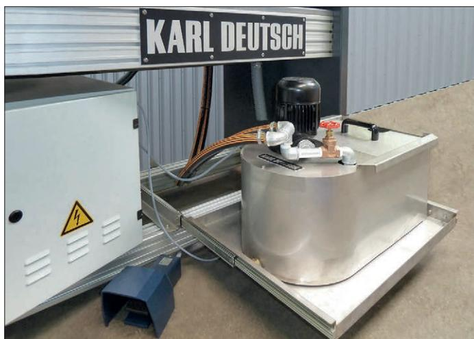
UWE 600 с выдвигаемым баком для магнитной суспензии с целью удобного выполнения замены вещества
