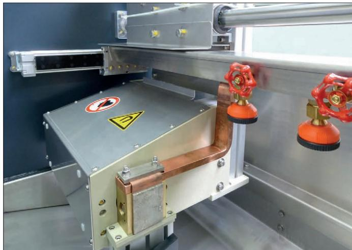
UMT 600 с пневматически перемещающейся системой полива
