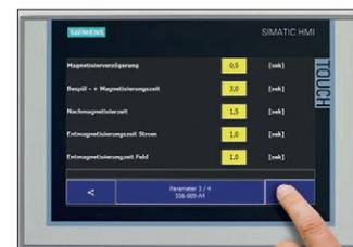
Возможна опция с памятью "DEUTROFLUX MEMORY": Управление через сенсорную панель Siemens с сохранением параметров (параметры намагничивания для конкретной детали, имена дефектоскопистов и др). Дополнительные варианты отчетов о проведении контроля для вывода на ПК или USB-носитель.
