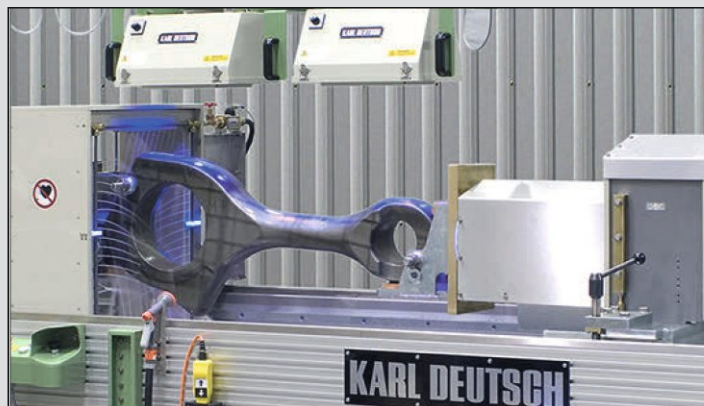
Контроль шатуна требует использования специальных опор с зажимами а так же возможность автоматизированного вращения детали для удобства осуществления осмотра.
