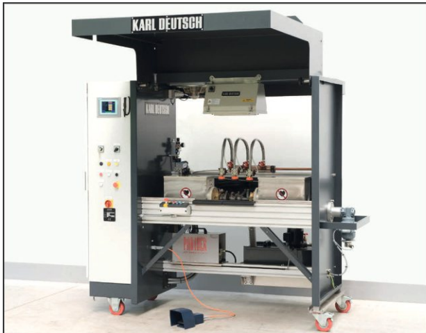
Система UWE 350 предназначена для контроля деталей длиной до 350 мм. Мобильный дефектоскоп на колесах с фиксаторами, с автоматизированной регулировкой длины, системой управления SIEMENS MEMORY SPS, опускающейся крышей. Идеально для небольших лабораторий.
