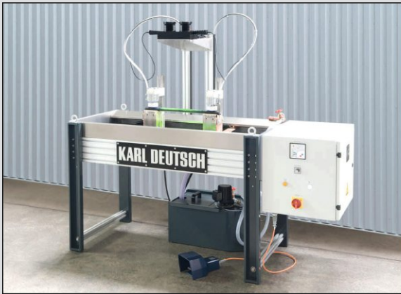
Система для магнитопорошкового контроля HW с автоматическим поливом, для циркулярного намагничивания (выявление продольных трещин). Оценка осуществляется с помощью двух съемных UV-LED светильников.
