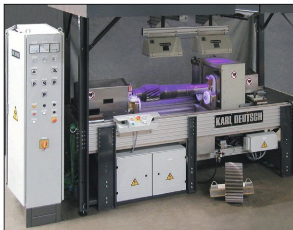
Комбинированная система UWS с UWE катушками, которая может использоваться для контроля больших и малых деталей. На фото показан контроль вала с зубчатой передачей.
