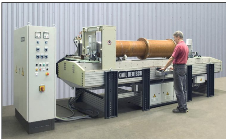
Контроль больших валов: UWS система с автоматизированной катушкой и усиленными опорными роликами для нагрузки до 4 тонн.
