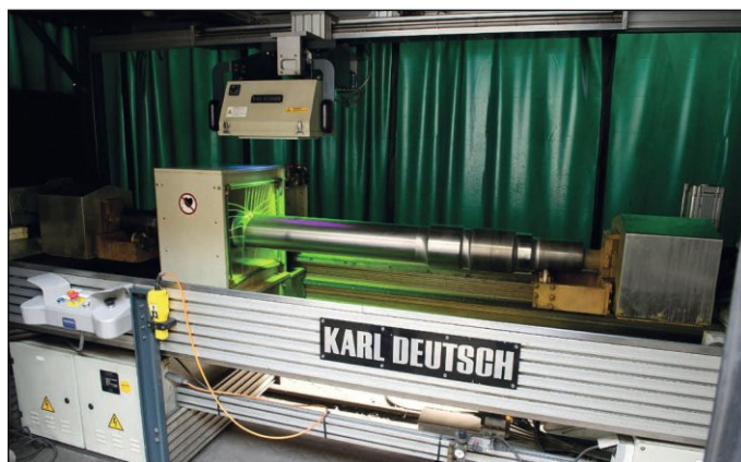
Контроль железнодорожных валов в системе UWS с автоматизированными вращающимися опорными роликами, и раздвижной крышей для загрузки деталей.
