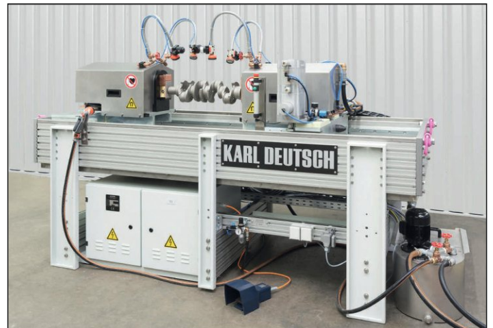
Специальная система UWE с усиленной заниженной рамой хорошо подходит для автоматизации контроля на промышленных предприятиях. Регулировку длины можно проводить как автоматизированно, так и вручную.
