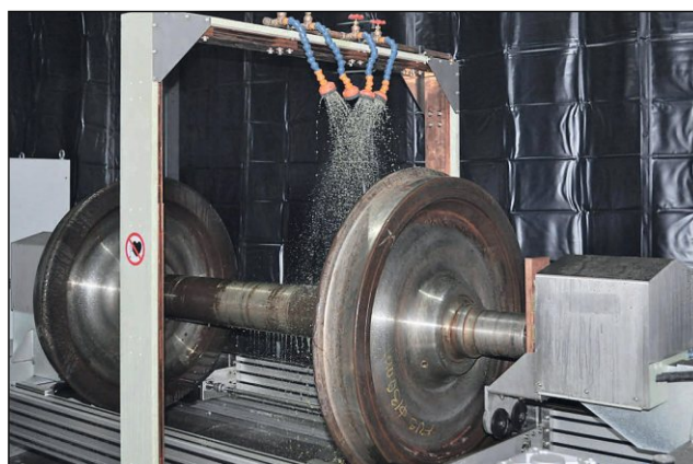
Контроль железнодорожных колес в сборе с помощью специальной увеличенной катушки с автоматизированным поливом.
